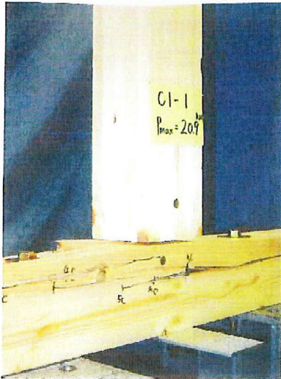
写真-1 破壊状況 試験体記号:C1-1 最大荷重:20.9kN
