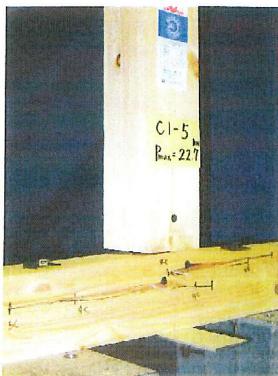
写真-5 破壊状況 試験体記号:C1-5 最大荷重:22.7kN
